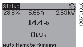
Рисунок 8.1: Шаг 1: Включите преобразователь частоты (зажигается светодиод On)
