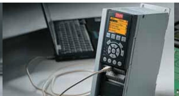
Мониторинг и программирование VLT® AutomationDrive можно осуществлять через USB-кабель или шину связи. Кроме того, предлагается большой ассортимент программного обеспечения, к примеру: VLT® Set-up, MCT 10, Language changer и др.
