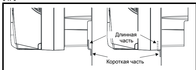
Рис. 5-17 Ориентация монтажного кронштейна для габарита 4, 5 и 6
