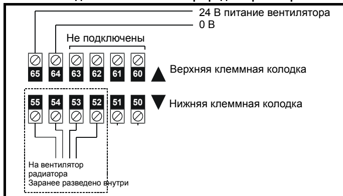
Рис. 5-34 Подключение вентилятора радиатора габарита 6
