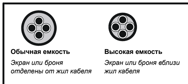
Рис. 8-1 Конструкция кабеля влияет на его емкость
